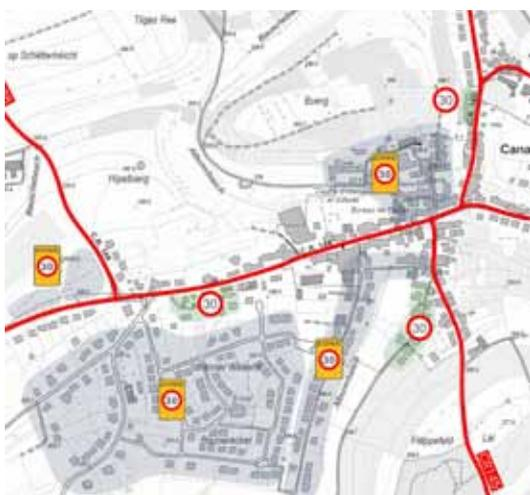
La hiérarchisation est basée sur le principe: 50km/h sur les voies de 1<sup>er</sup> ordre et 30km/h sur les voies de 3<sup>e</sup> ordre. Canach ne dispose pas de voies de 2<sup>e</sup> ordre.
