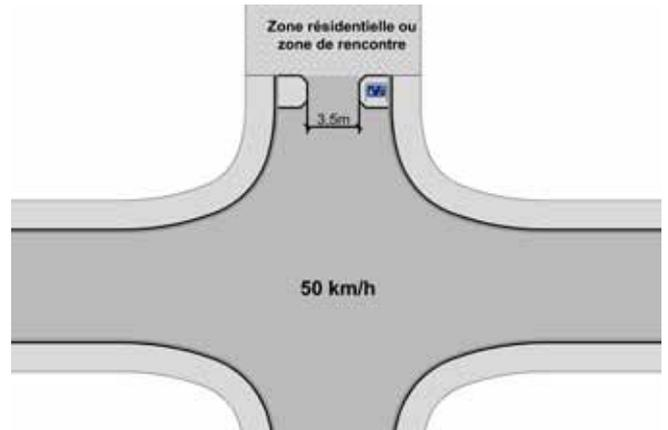
4. entrée située en section courante, avec une vitesse d'approche limitée soit à 50km/h, soit à 30km/h et où l'automobiliste continue en ligne droite pour entrer dans la zone :
