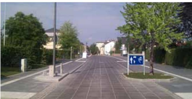
La zone résidentielle et la zone de rencontre sont indiquées par les signaux E,25a et E,26a. Ces signaux sont à mettre en place du côté droit de la chaussée, dans le champ visuel des automobilistes (art. 108 du Code de la Route). Dans le sens de la sortie, les signaux E,25b et E,26b indiquent la fin des dites zones. Ils peuvent être placés au revers des signaux E,25a et E,26a, tels que représentés ci-avant.
