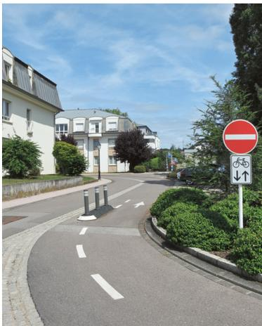
Sicherung der Freigabe in Gegenrichtung für den Radverkehr in einer verkehrsberuhigten Zone
