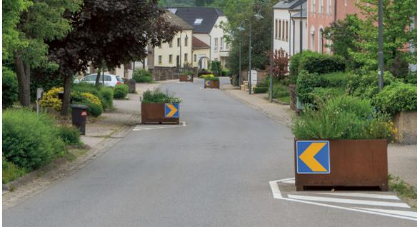
Absenkung der Geschwindigkeit durch Aufstellen von Pflanzkübeln
