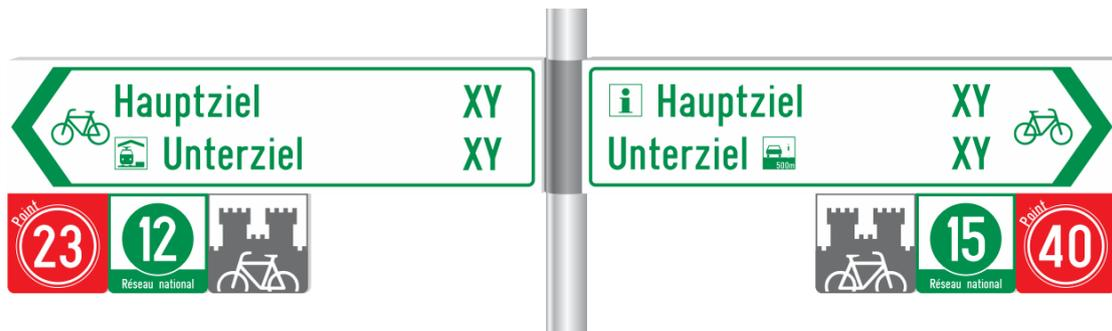
Abbildung 31: Pfeilwegweiser mit Einschubplaketten
