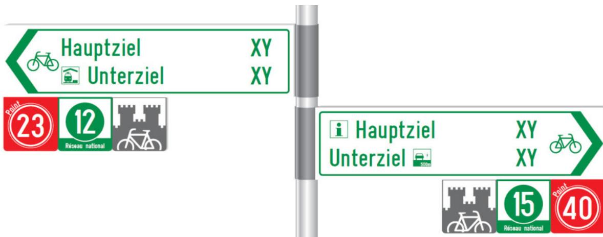
Abbildung 76: Gestufte Montage von Pfeilwegweisern
