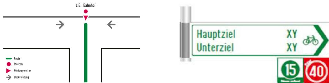
Abbildung 37: Pfeilwegweiser an Standort mit einer Richtung
