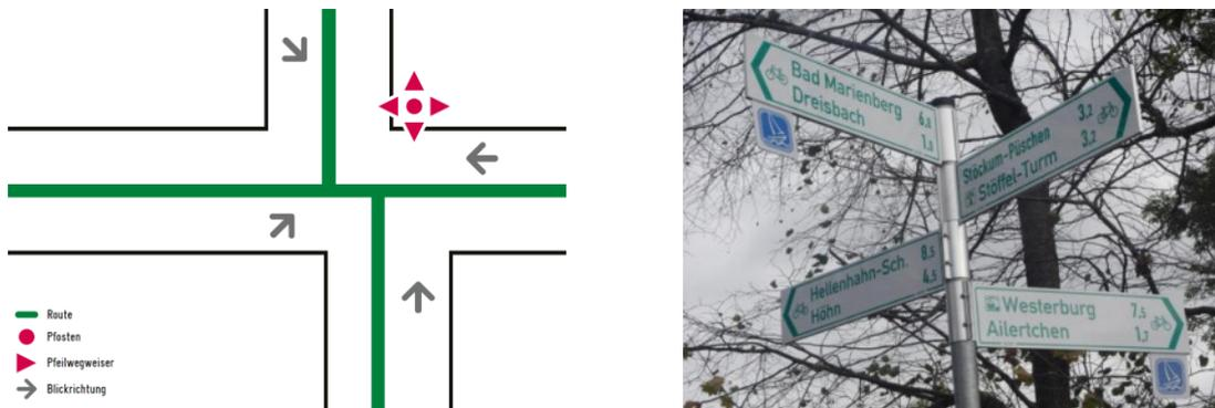
Abbildung 36: Pfeilwegweiser an Kreuzungen mit vier Richtungen
