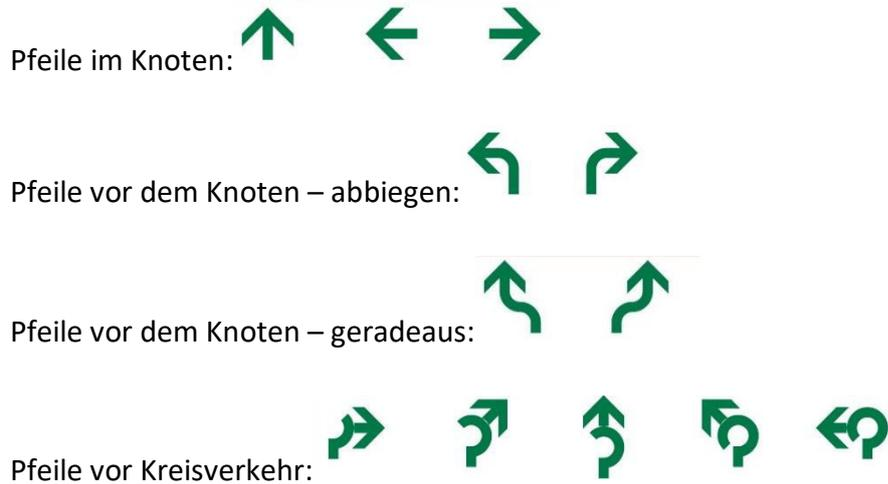
Abbildung 44: Verwendbare Pfeilausrichtungen
