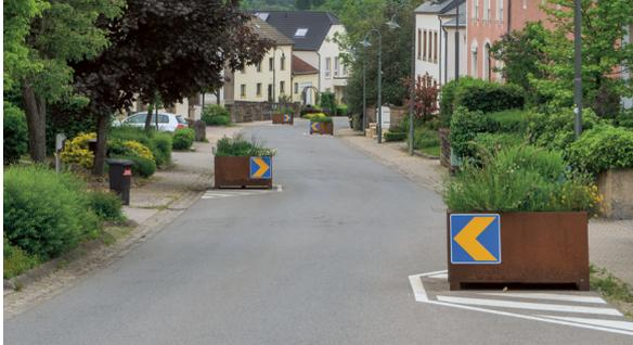
Absenkung der Geschwindigkeit durch Aufstellen von Pflanzkübeln
