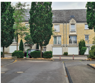
Durchlässige Sackgasse mit baulicher Verengung in Form einer bepflanzten Verkehrsinsel
