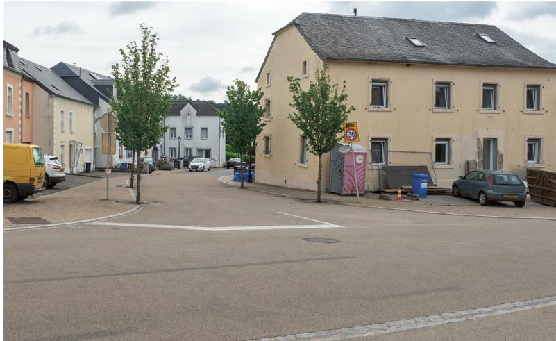
*Aménagement d'une transition depuis une route de liaison limitée à 30 km/h (en avant-plan) vers une route de distribution également limitée à 30 km/h*
