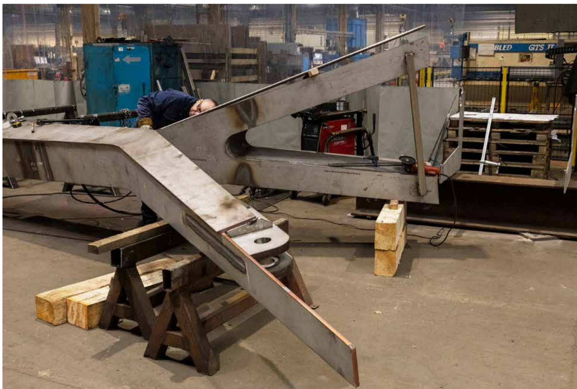
La grande pile sur laquelle la passerelle s'appuiera à côté du bastion.
