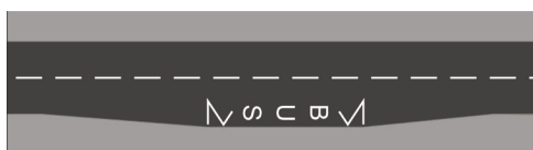
Aménagement en demi-encoche
