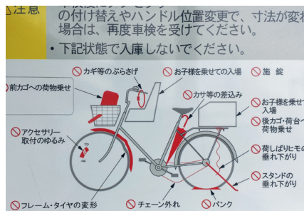
Il accessoires ou équipements non acceptés par le système automatisé (Osaka)
